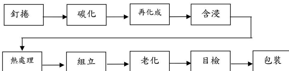
B. 晶片型導電高分子固態電容器
